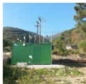
Σταθμός παρακολούθησης ποιότητας αέρα, μέρος του συστήματος περιβαλλοντικής παρακολούθησης της Ελληνικός Χρυσός.
